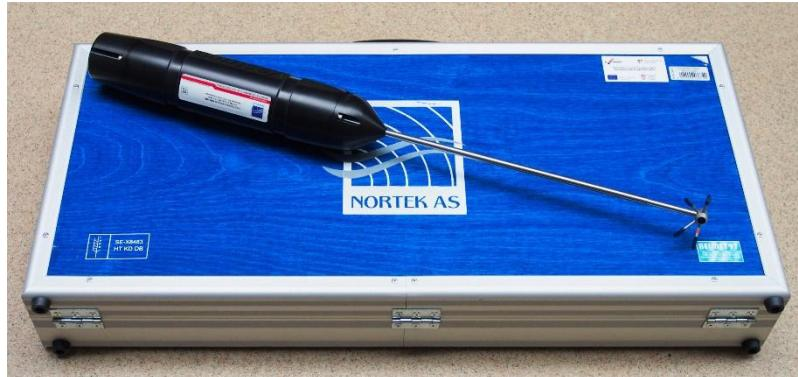
**Kratki opis opreme:** *Mjerni pretvornik se koristi u svrhu definiranja vektora brzine. Mjerni pretvornik radi na bazi ultrazvučne tehnologije te time značajno umanjuje interakciju s mjerenim poljem.*
