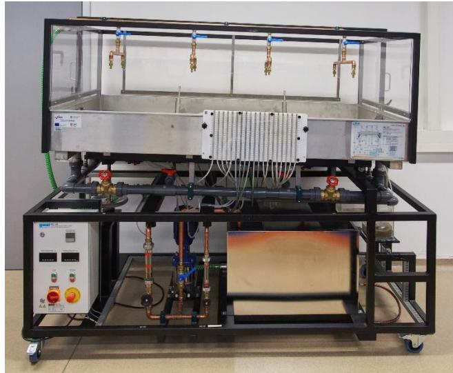
**Kratki opis opreme:** Komora za napredna hidrološka ispitivanja opremljena s 8 mlaznicama putem kojih je moguće modelirati različite hidrološke uvjete. Komora ima nagibno dno te se tako može koristiti u svrhu analiziranja erozije površinskog materijala.
