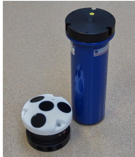
**Kratki opis opreme:** Acoustic Waves and Currents (AWAC) se koristi u svrhu dugotrajnijih mjerjenja karakteristike morskih struja i valova na dubinama do 10m.
