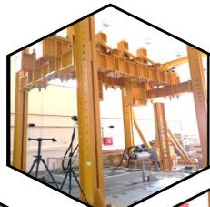
**Mosna dizalica** od 5 tona na radnom prostoru od 8,6x16 m s visinom dizanja od 7,28m
