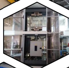
Ubrzano ispitivanje otpornosti materijala na koroziju u **cikličkoj slanoj komori**
