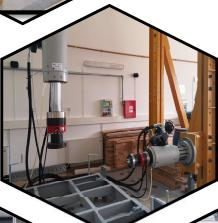
Ispitivanje malih uzoraka u **temperaturnoj komori** pod utjecajem temperature do +250°C do 10 kN
